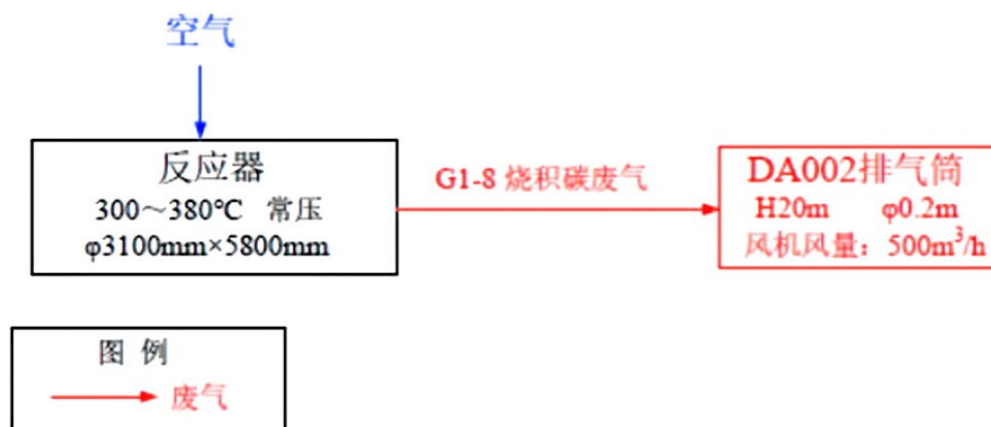
图 3.4-4 邻甲酚装置催化剂再生工艺流程及产污环节图(烧积碳)
